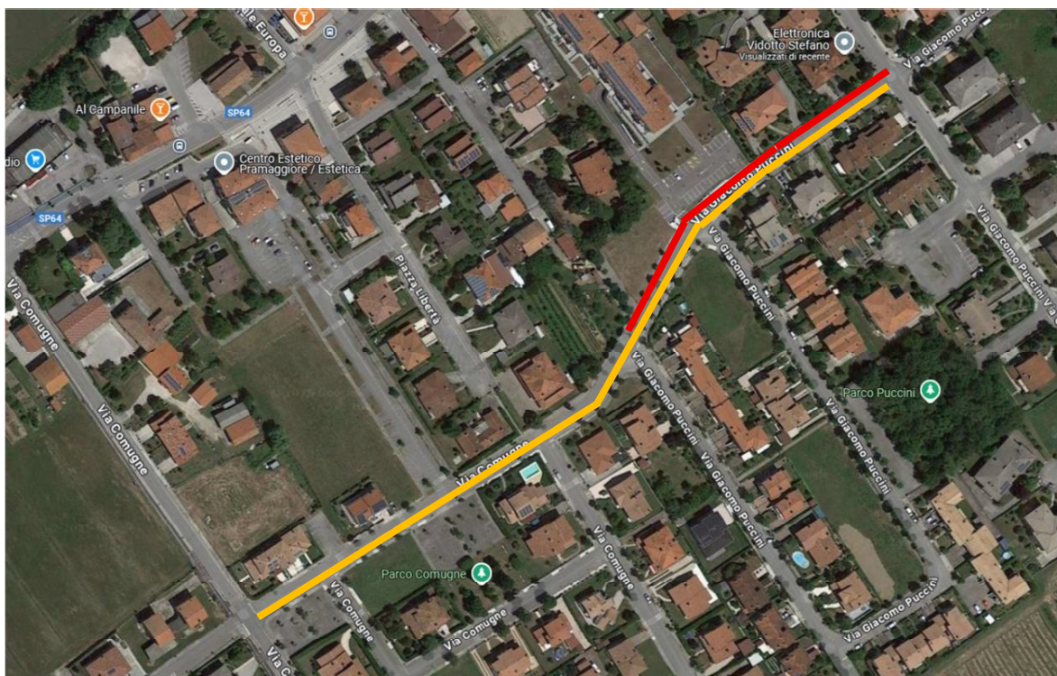
Figura 1: Planimetria delle aree interessate dai lavori: linea rossa nuova fognatura mista via Puccini, linea gialla nuova fognatura nera via Puccini e via Comugne
